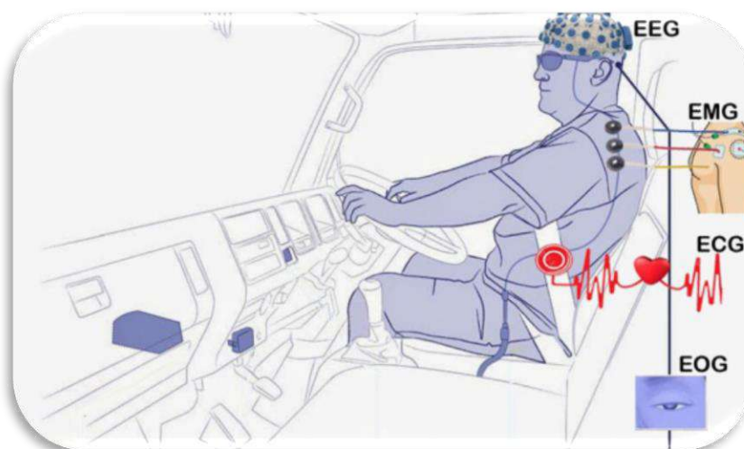
2-Rasm. Charchoqni aniqlash uchun haydovchining fiziologik signallari o'lchash holati
